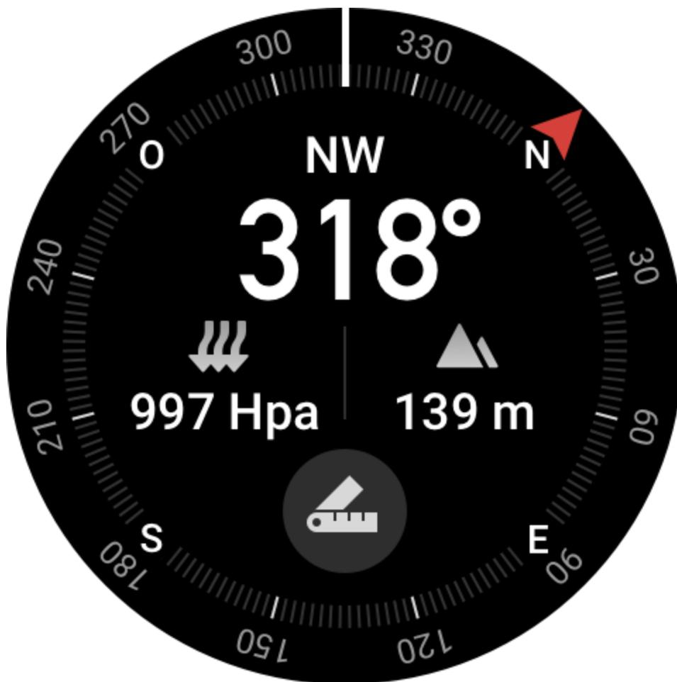
Tocca il pulsante sullo schermo per bloccare la posizione corrente delle ore 12. Poi, quando cambi direzione, l'interfaccia visualizzerà l'angolo tra la nuova direzione delle ore 12 e la precedente direzione delle ore 12.
